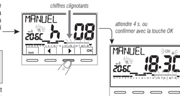
(i) Avec la fonction manuelle temporaire activée, il est possible de modifier le set de température autonome à une date ultérieure en appuyant sur les touches **▲▼**, ou de modifier sa durée en appuyant sur **OK** et successivement **◀▶**.
