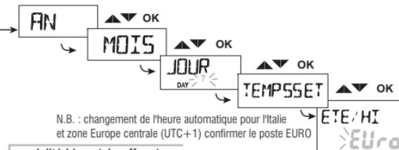
Appuyer sur les Touches **▲▼** pour modifier (pressées à impulsions, on augmente ou diminue d'une unité, en appuyant de manière prolongée, le déroulement rapide s'active).
