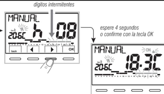
**Con la función de manual temporal activada, se puede cambiar el set de temperatura autónomo en otro momento, presionando las teclas , o su duración presionando **OK** y seguidamente .**
