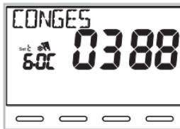
Le thermostat programmable commence le compte à rebours (ex. : sur l'image: 388 heures) jusqu'à la fin des heures programmées; en mode HIVER il activera l'utilisation connectée uniquement dans le cas où la température ambiante descend en-dessous du set de température antigel configuré (par défaut 6,0 °C). Une fois le compte à rebours terminé, le programme CONGÉS réinsère votre programme habituel.
