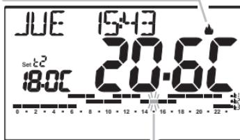
El dígito intermitente indica la hora actual correspondiente al nivel y al set de temperatura configurado.
