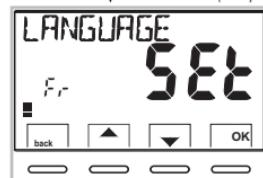
L'utilisation des touches **▲▼** permet de naviguer dans les menus : en appuyant sur **OK** on entre dans le menu sélectionné, en appuyant sur **back** on revient à la rubrique précédente. Dans les menus les configurations doivent être confirmées en appuyant sur la touche **OK** là où cela est requis, sinon, après 3 minutes, le thermostat programmable revient à un fonctionnement normal en mode veille et les modifications ne sont pas enregistrées.
