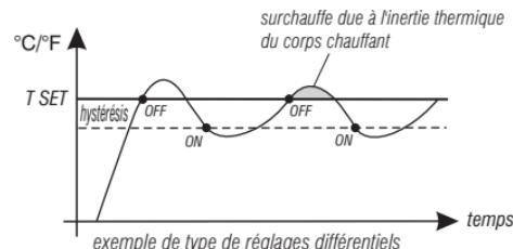
**En alternative** au différentiel thermique, il est possible de régler la température de façon **PROPORTIONNEL PAR MODULATION (PROP)**; la durée du cycle est réglable de 7 à 20 minutes (défaut 10 minutes); ce système permet de maintenir la température souhaitée plus stable, en augmentant la sensation de confort pour l'utilisateur et en économisant sur les consommations d'énergie.
