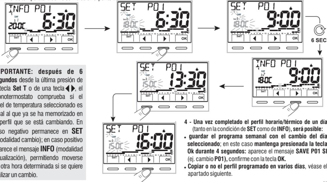
**IMPORTANTE: después de 6 segundos** desde la última presión de la tecla **Set T** o de una tecla **◀ ▶**, el cronotermostato comprueba si el nivel de temperatura seleccionado es igual al que ya se ha memorizado en el perfil que se está cambiando. En caso negativo permanece en **SET** (modalidad cambio); en caso positivo aparece el mensaje **INFO** (modalidad visualización), permitiendo moverse en otra hora determinada si se quiere realizar un cambio.
