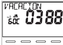
El cronotermostato comienza el conteo regresivo (ej. en la figura: 388 horas) hasta que se acaben las horas programadas; en modalidad INVIERNO activa el equipo conectado solo si la temperatura ambiente se coloca por debajo del Set de temperatura antihielo configurado (por defecto 6.0 °C).
