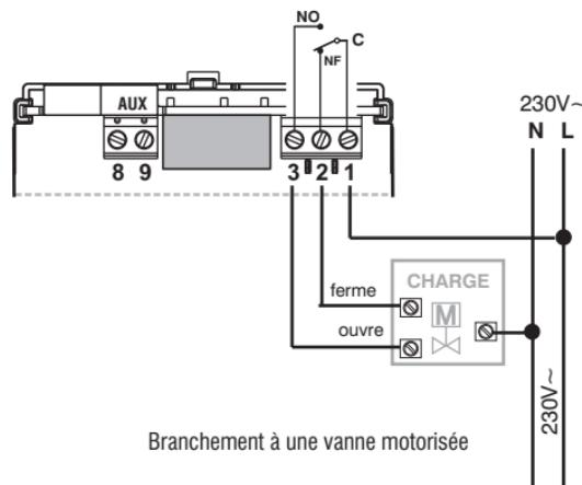
N.B.: avec des charges inductives importantes (pompes et électrovannes), il est conseillé de connecter un filtre RC en parallèle à la charge.
