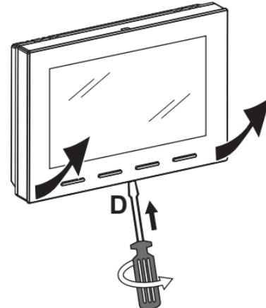
Desenganche el cronotermostato de la base de pared haciendo palanca con un destornillador en el hueco específico (**D**) presente en la parte inferior del dispositivo; después, extraígalo.
