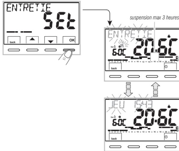
Pour réactiver le programme interrompu avant la fin des 3 heures, appuyer sur **back** ou ⌂ : l'indication «**ENTRETIEN**» disparaît.
