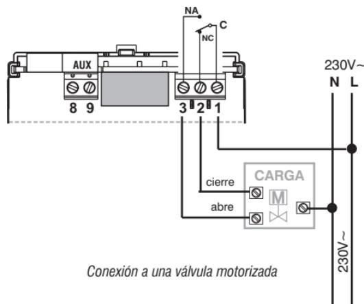
Conección a una válvula motorizada
