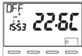
3- Presione la tecla **↓** para volver a activar el cronotermostato y volver al programa configurado con anterioridad.
