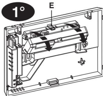
Accrocher le thermostat programmable sur la base murale dans les ergots **C**. Puis tourner le corps du thermostat programmable vers le bas jusqu'à ce qu'il soit fixé dans l'encoche **D** (CLIC indiquant la bonne fixation).
