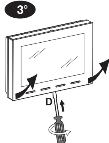
Décrocher le thermostat programmable de la base murale en appuyant à l'aide d'un tournevis dans la fente spécifique (**D**) située dans la partie inférieure du dispositif, puis l'extraire.
