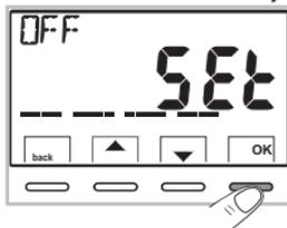
2- En el display aparece el mensaje **OFF**, para indicar que el cronotermostato está desactivado y todas las funciones están inactivas; permanecen en funcionamiento solo la visualización del día, la hora actual, la lectura de la temperatura ambiente y (en modalidad INVIERNO) el símbolo de protección antihielo **t\***.
