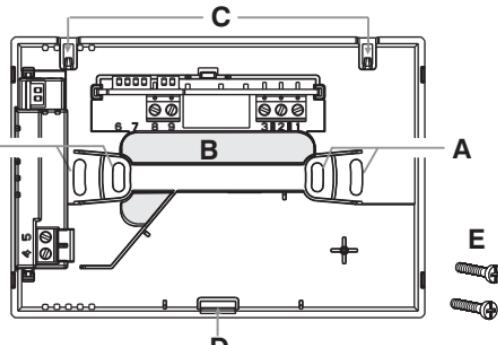
A - huecos de fijación de la base: en muro, caja empotrada redonda o rectangular
