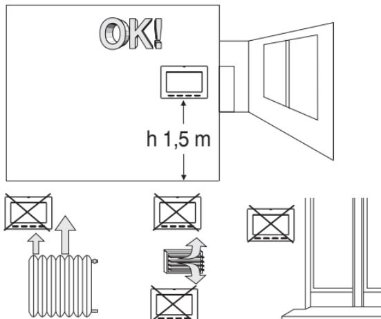
Se recomienda instalar el termostato a una altura de 1,50 a 1,60 mts del suelo, lejos de fuentes de calor, tomas de aire, puertas, ventanas o cualquier otro medio que influya en su funcionamiento.
