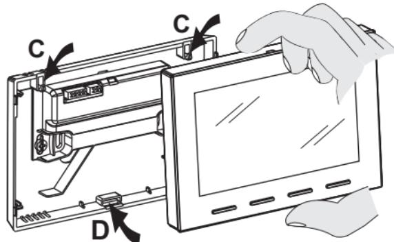
Pričvrstiti vremenski termostat na bazu za postavljanje na zid u kuke **C**.
