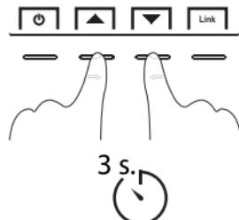
Za blokadu tipkovnice istovremeno pritisnuti tipke **▲ ▼** u trajanju od 3 sekunde, na zaslonu će se pojaviti znak (lokot).
