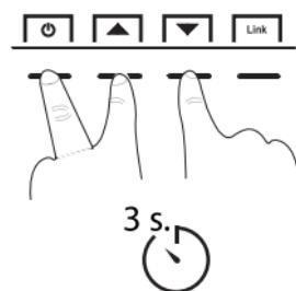
Za vraćanje vremenskog termostata natrag u tvorničke postavke, izvršiti operaciju reset-a, istovremenim pritiskom na tipke **⌚ ▲ ▼** u trajanju od 3 sek.
