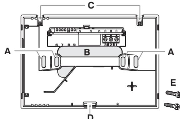
**A** - otvori za pričvršćivanje baze: na zid, ugrađena okrugla ili pravokutna kutija
