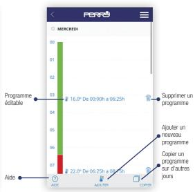
La programmation quotidienne (10 programmes maximum par jour) peut être définie pendant une durée minimum d'une minute et pour un écart de température minimum de 0,5 °C.
