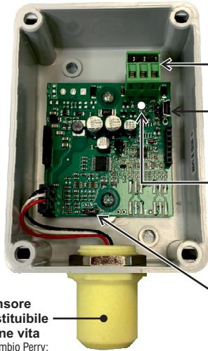
Sensore sostituibile a fine vita
