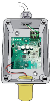
Sonda con sensore da sostituire
