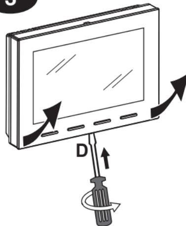
Den Uhrenthermostat durch Drücken mit einem Schraubendreher in die entsprechende Aussparung **D** unten am Gerät von der Wandhalterung lösen.
