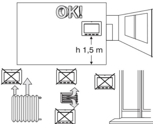
Den Uhrenthermostat vorzugsweise auf einer Höhe von 1,50 - 1,60 m vom Boden installieren - fern von Wärmequellen, Belüftungsöffnungen, Fenstern, Türen oder anderer Beeinflussung dessen Betriebs.
