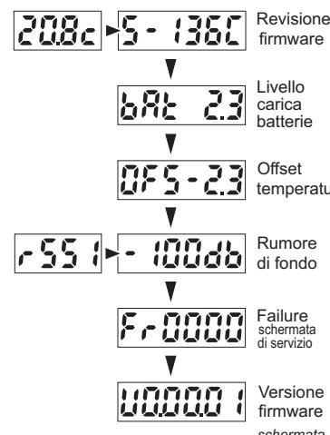
All'uscita dal menù il sensore esegue un test di trasmissione e ricezione quindi torna a visualizzare la temperatura ambiente rilevata.
