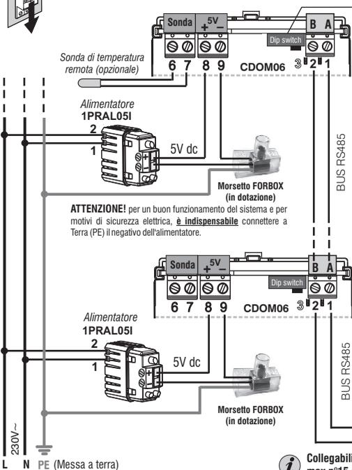
**Dip switch** Verificare che sia in posizione di riposo, spostare in altra posizione solo su indicazione dell'assistenza tecnica (impianti speciali)
