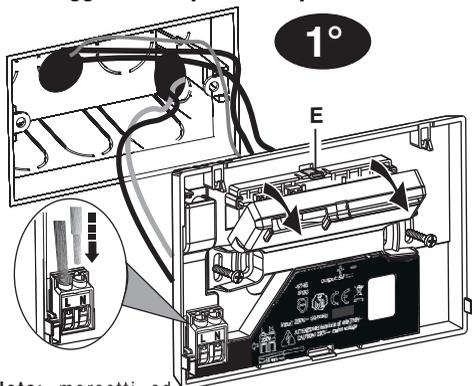
**Nota:** morsetti ad aggancio rapido dei cavi di alimentazione, inserirli direttamente senza ausilio di un cacciavite.
