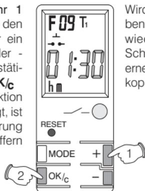
Wird auch die **Schaltuhr 2** benötigt, blendet das Display wieder die Einstellung der Schaltuhr 1 ein, die durch erneuten Druck auf Taste **OK/c** kopiert werden kann;
