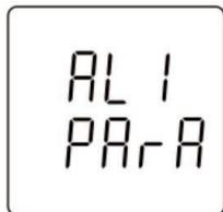
Menu di impostazione dei parametri di allarme per il **canale 1**. Premere il **pulsante 2** per 3 secondi per accedere alla schermata di selezione dei parametri di allarme.
