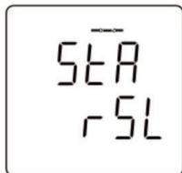
La figura di sinistra indica che non è scattato alcun allarme e che il relè è in stato di connessione.
