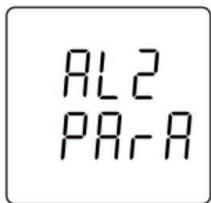
Menu di impostazione dei parametri di allarme per il **canale 2**.
