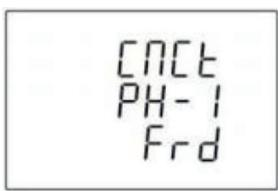
È possibile impostare la correzione della direzione corrente L1: avanti(frd) o indietro(rev), l'impostazione predefinita è avanti.
