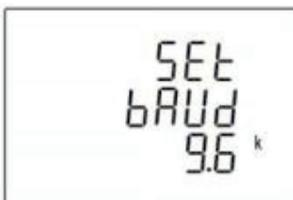
La velocità di trasmissione può essere impostata: 1200, 2400, 4800, 9600, 19200, 38400 bps, l'impostazione predefinita è 9600 bps.
